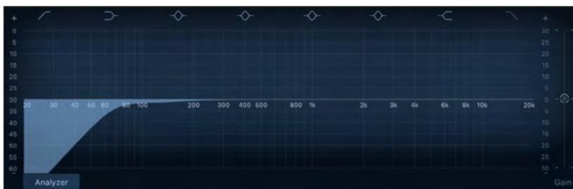
Fig. 3 - Equalizzatore impostato con filtro passa-alto a 100 Hz circa (è stato utilizzato un Eq. di GarageBand)
